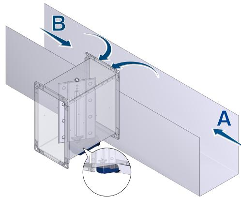
**Za smer strujanja vazduha A u glavnom kanalu:** Za specificiranu preciznost zapreminskog protoka  $\Delta q_v$  potrebno je uzeti u obzir dodatnih 10% u gornjoj trećini opsega nominalnog protoka vazduha.
