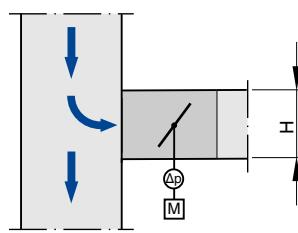
Koleno bez dodatnog ravnog dela uz vazdušnu struju ispred uređaja za regulaciju promenljivog protoka vazduha nema značajan uticaj na preciznost regulisanja zapreminskog protoka  $\Delta q_v$ .
