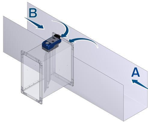
**Za smer strujanja vazduha A u glavnom kanalu:** specificirana preciznost zapreminskog protoka  $\Delta q_v$  se može postići.
