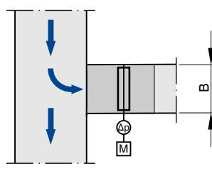
Koleno bez dodatnog ravnog dela uz vazdušnu struju ispred uređaja za regulaciju promenljivog protoka vazduha nema značajan uticaj na preciznost regulisanja zapreminskega protoka  $\Delta q_v$ .
