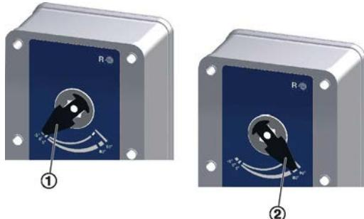
Slika 20: Indikator položaja lamele za zatvaranje klapne
