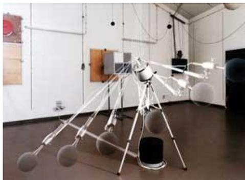
TROX akustika poseduje 2 reverberacione komore. One zadovoljavaju preporuke za reverberacione komore u skladu sa ISO 3741 (određivanje nivoa zvučne snage izvora buke na osnovu zvučnog pritiska — Precizna metoda za reverberacione ispitne komore). U akustičkoj laboratoriji se vrše zvučna merenja. Ova merenja se koriste kao smernice ili podrška pri razvoju novih proizvoda.
